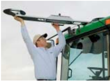
Das Doppelantennemodul lässt sich einfach von einer Maschine auf die andere umsetzen.
